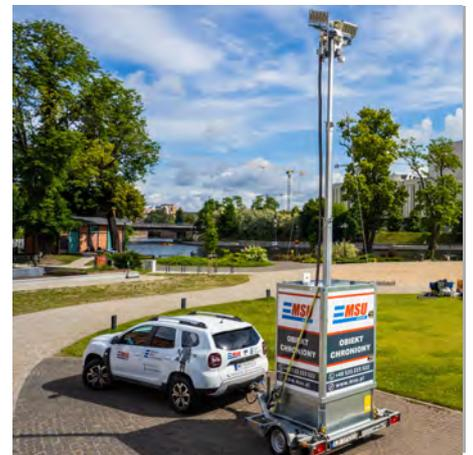
Ununterbrochene 24/7-Überwachung – Das MSU-Operationszentrum überwacht das Gebiet mit 360-Grad-Kameras, die auf einem 7 Meter hohen Teleskopmast montiert sind.
